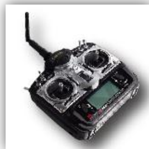
手持式無線遙控器 含有九頻道遙控發 射器，並能同時控 制攝影機角度、縮 放及拍攝動作。
